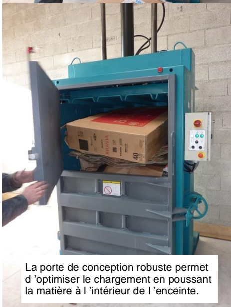
Les déchets sont chargés dans la trémie de chargement.
